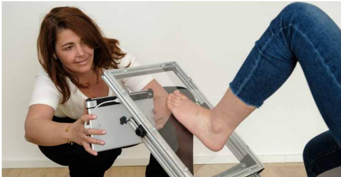
Das ScanPed besteht aus einer transparenten Platte, welche auf einem aus Aluminium gefertigten Rahmen fixiert ist. Dies ermöglicht die einfache Handhabung der stufenlosen Höhenverstellung und der in zehn Stufen einstellbaren Winkelanpassung. Durch die Stellfüße ist ein Anpassen an unebene Untergründe möglich. Die Gummipuffer unter den Füßen verhindern ein Verrutschen der Plattform während des Scanvorgangs.
